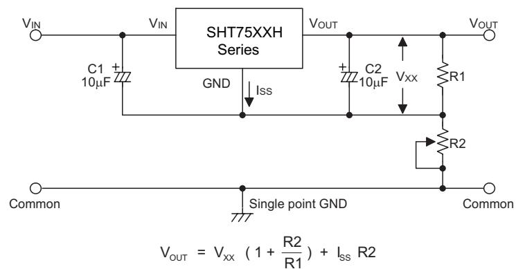
$$V_{OUT} = V_{xx} \left( 1 + \frac{R2}{R1} \right) + I_{ss} R2$$
