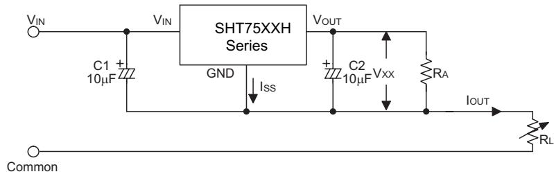
$$I_{OUT} = \frac{V_{XX}}{R_A} + I_{ss}$$
